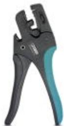
Инструмент для снятия изоляции, для проводов и линий 0,02 - 10 мм<sup>2</sup>, самонастраивающийся, длина снятия изоляции 18 мм, сила реза до 10 мм<sup>2</sup> гибких /1,5 мм<sup>2</sup> жестких, сменный нож для снятия изоляции
