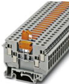
Клеммы с ножевыми размыкателями, с винтами для крепления контрольного штекера, Тип подключения: Винтовые зажимы, Сечение: 0,2 мм<sup>2</sup> - 6 мм<sup>2</sup>, AWG: 24 - 10, Номинальный ток: 16 А, Номинальное напряжение: 630 В, Длина: 63,5 мм, Ширина: 6,2 мм, Цвет: серый, Монтаж: NS 35/7,5, NS 35/15, NS 32
