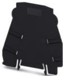
Изоляционная пластина, толщина 2 мм, устанавливается в начале и конце каждой клеммной колодки PLC. Служит для: оптической развязки групп, безопасного разделения различных напряжений расположенных рядом интерфейсных модулей PLC в соотв. с DIN VDE 0106-101, разделения
