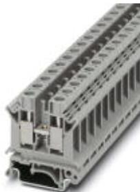
Проходные клеммы, Тип подключения: Винтовые зажимы, Сечение: 0,5 мм<sup>2</sup> - 16 мм<sup>2</sup>, AWG: 20 - 6, Ширина: 10,2 мм, Цвет: серый, Тип монтажа: NS 35/7,5, NS 35/15, NS 32
