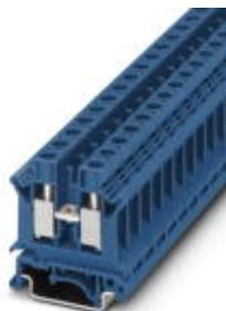
Проходные клеммы, Тип подключения: Винтовые зажимы, Сечение: 0,5 мм<sup>2</sup> - 16 мм<sup>2</sup>, AWG: 20 - 6, Ширина: 10,2 мм, Цвет: синий, Тип монтажа: NS 35/7,5, NS 35/15, NS 32
