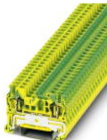
Заземляющий клеммный модуль с пружинными зажимами, Тип подключения: Пружинный зажим, Сечение: 0,08 мм<sup>2</sup> - 4 мм<sup>2</sup>, AWG: 28 - 12, Ширина: 5,2 мм, Цвет: желто-зел., Тип монтажа: NS 35/7,5, NS 35/15
