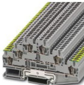
Заземляющий клеммный модуль с пружинными зажимами, Тип подключения: Пружинный зажим, Сечение: 0,08 мм<sup>2</sup> - 4 мм<sup>2</sup>, AWG: 28 - 12, Ширина: 5,2 мм, Цвет: серый, Тип монтажа: NS 35/7,5, NS 35/15
