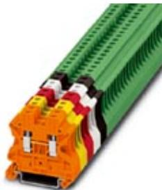
Проходные клеммы, Тип подключения: Винтовые зажимы, Сечение: 0,14 мм<sup>2</sup> - 6 мм<sup>2</sup>, AWG: 26 - 10, Ширина: 6,2 мм, Цвет: черный, Тип монтажа: NS 35/7,5, NS 35/15
