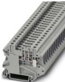
Клемма с размыкателем , Тип подключения: Винтовые зажимы, Сечение: 0,14 мм<sup>2</sup> - 6 мм<sup>2</sup>, AWG: 26 - 10, Номинальный ток: 20 А, Номинальное напряжение: 500 В, Длина: 57,8 мм, Ширина: 6,2 мм, Цвет: серый, Монтаж: NS 35/7,5, NS 35/15
