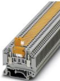
Клеммы с ножевыми размыкателями, Тип подключения: Винтовые зажимы, Сечение: 0,2 мм<sup>2</sup> - 4 мм<sup>2</sup>, AWG: 24 - 12, Номинальный ток: 16 А, Номинальное напряжение: 400 В, Длина: 46 мм, Ширина: 5,2 мм, Цвет: серый, Монтаж: NS 35/7,5, NS 35/15, NS 32
