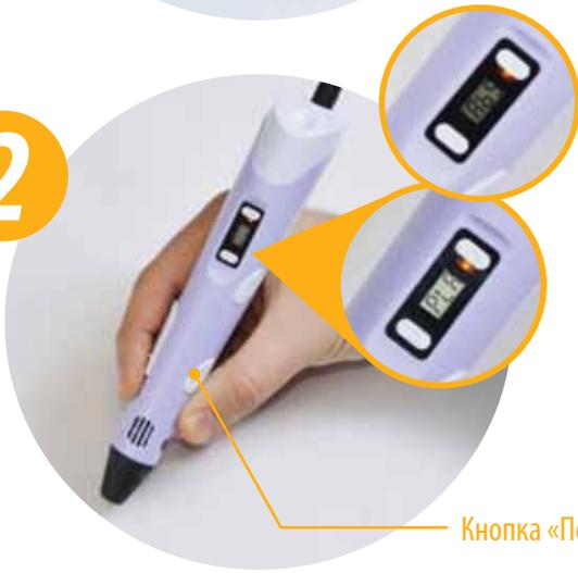
Кнопкой регулировки температуры выберите материал, с которым Вы собираетесь работать «PLA» или «ABS». Далее нажмите кнопку подачи пластика, и ручка автоматически начнет прогрев до необходимой температуры для этого вида пластика. Во время прогрева будут гореть красный и желтый индикаторы, на ЖК-дисплее Вы увидите, как идет прогрев устройства. Подождите 0,5 минуты, пока красный индикатор изменится на зеленый, это означает, что устройство готово к использованию.
