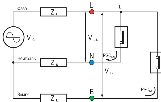
VG – напряжение генератора на холостом ходу;
