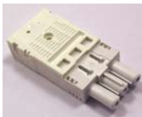
GESIS GST18i3, пружинный зажим провода 3x1.5-2.5 мм, 2 провода на полюс, фиксация кабеля (защелка-фиксатор разъемов см. 05.587.3156.1)
