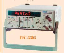
можности измерений: периода от 10 нс до 100 с; временных интервалов и длительности импульсов от 250 нс до 5 с; скважности от 1% до 99 %; частоты вращения от 1 до 480000 об/мин.
