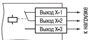
Рис. Б.2. Схема подключения к ВЭ типа Р
