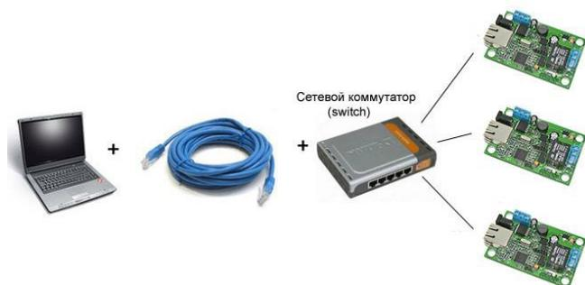
Рис. Схема подключения нескольких модулей к одной сети с использованием switch
