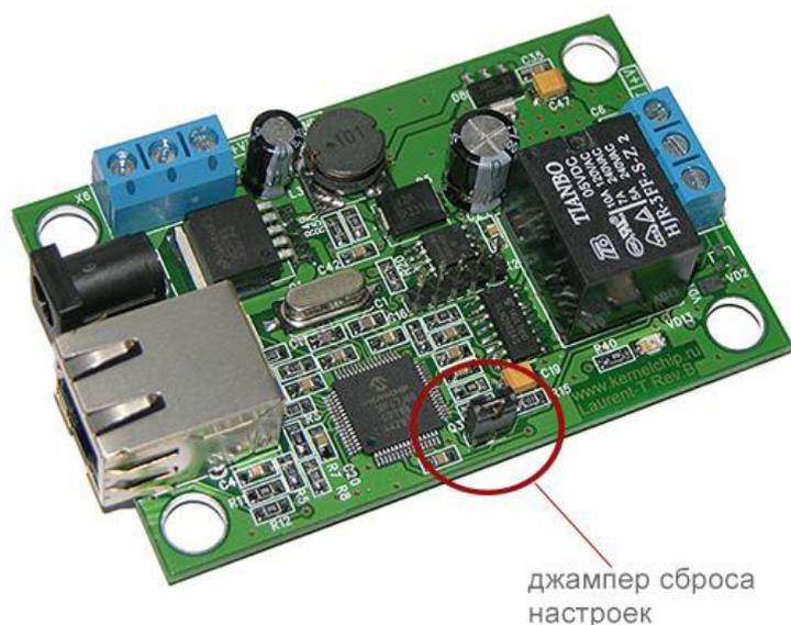
Рис. Расположение джампера сброса настроек на плате MP719
