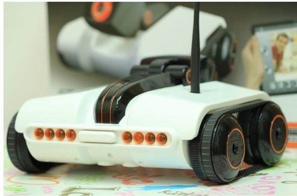
SPY-C Tank оснащен подвижной HD камерой, передающей видео на устройство в реальном времени и возможностью управлять наклоном камеры с телефона или планшета.
