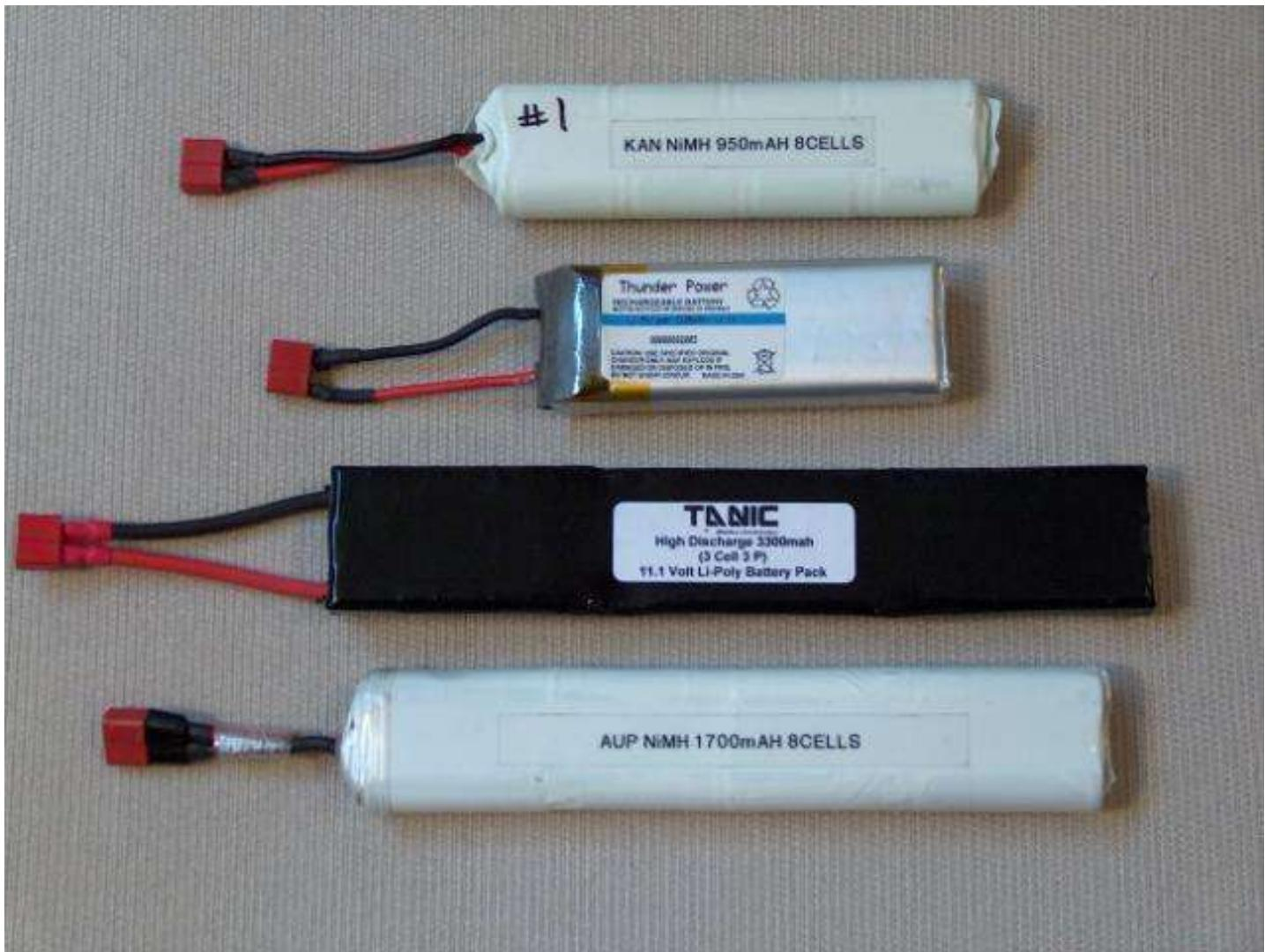
Очень хорошо зарекомендовали себя литий-полимерные аккумуляторы на небольших вертолётах, таких, как Piccolo или Hummingbird – например, даже при использовании стандартного коллекторного мотора время полёта на двух банках ёмкостью 1 А<sup>ч</sup> составляет более 25 минут! А при замене мотора на бесколлекторный – более 45 минут!
