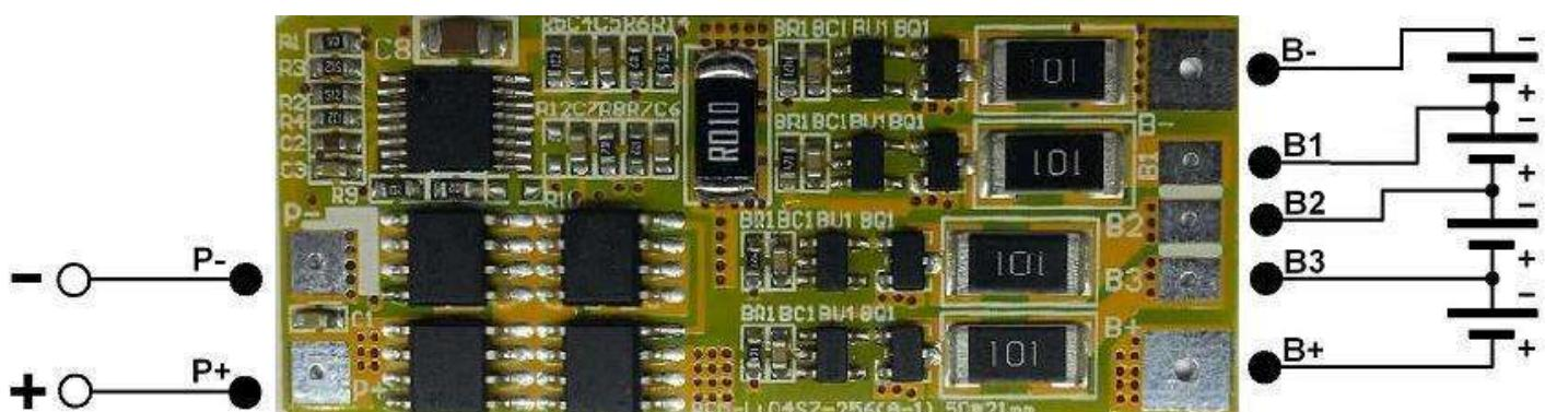
Если вы подключаете контроллер к аккумулятору впервые, возможно, он не запустится с первого раза. Чтобы уладить этот момент необходимо подключить зарядное устройство к контроллеру, чтобы логика контроллера работы вышла в штатный режим.
