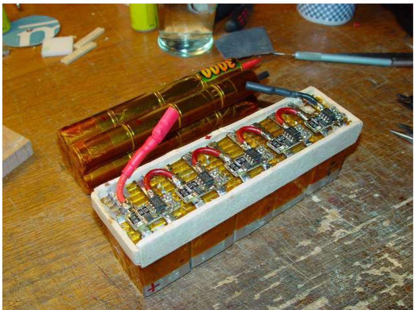
Следует добавить, что от переразряда некоторых банок в разбалансированной батарее балансёр не спасает, он служит только для защиты от повреждения элементов при заряде и средством индикации "плохих" элементов в батарее. Вышесказанное относится к батареям, составленным из 3-х и более элементов, для 2-х батарей балансёры, как правило, не применяют.
