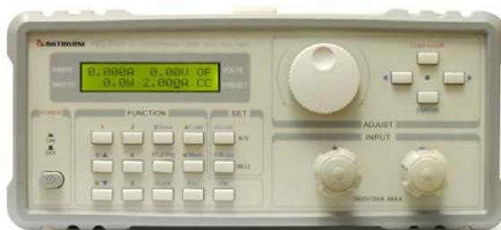
Электронная программируемая нагрузка предназначена для работы в качестве нагрузки при испытании, настройке и регулировке блоков питания, усилителей, звуковоспроизводящей аппаратуры и других радиотехнических устройств с напряжением питания до 360 В, током нагрузки до 30 А, потребляемой мощностью до 300 Вт.
