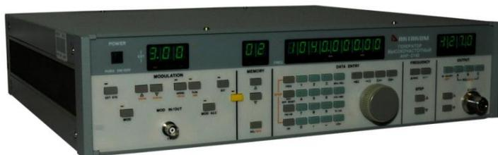
Функциональные генераторы АНР-2140 предназначены для исследования радиочастот в пределах от 100 кГц до 300 МГц, а также АМ и ЧМ модуляции с изменением шага выходной функции в 0.1 дБ. Генераторы используются для настройки приемопередающей аппаратуры
