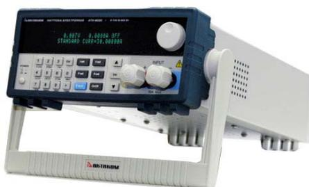
Программируемая электронная нагрузка предназначена для работы в качестве нагрузки при испытании, настройке и регулировки блоков питания, усилителей, звуковоспроизводящей аппаратуры и других радиотехнических устройств с напряжением питания до 500 В, током нагрузки до 15 А, мощность поглощения до 300 Вт.
