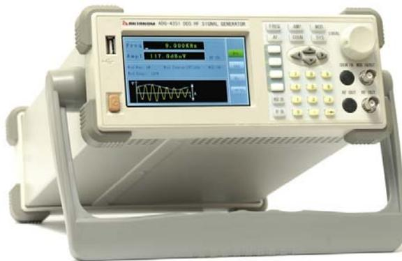
Генератор ADG-4351 используют технологию прямого цифрового синтеза (DDS) и представляют собой источник стабильных высокоточных выходных сигналов синусоидальной формы с частотным диапазоном от 9 кГц до 350 МГц и с уровнем выходного сигнала от -127 дБм до +13 дБм. Генератор может выдавать немодулированный сигнал, а также выдать сигналы с АМ, ФМ, ЧМ, ФМН, ЧМн модуляциями и работать в режиме качания частоты.
