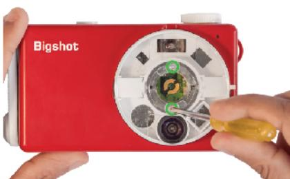
D9. После этого закрепите крышку объективов двумя винтами.
