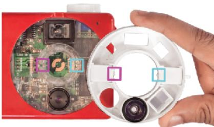
D5. Закройте крышкой вторую пружину.
