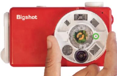
D7. После установки колеса объективов попробуйте аккуратно повернуть его в обоих направлениях. Колесо должно фиксироваться в любом из трех положений.
