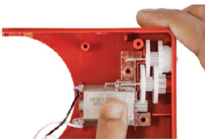
**B8.** Сверху на генератор установите фиксатор таким образом, чтобы фиксатор удерживал генератор и оси зубчатых колес.
