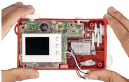
**C3.** Поднимите электронный блок и поверните диск установки режима в положение, показанное выше.
