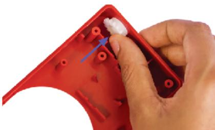
**В1.** Установите зубчатое колесо А в отверстие в боковой части корпуса камеры. Направление установки зубчатого колеса показано синей стрелкой.
