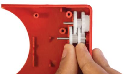
**В5.** Возьмите собранные вместе зубчатые колеса и поместите их под первую парой зубчатых колес, как показано на рисунке. Проверьте, чтобы левый конец оси был расположен в углублении в корпусе камеры.
