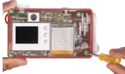
C13. С помощью четырех винтов закрепите заднюю крышку.
