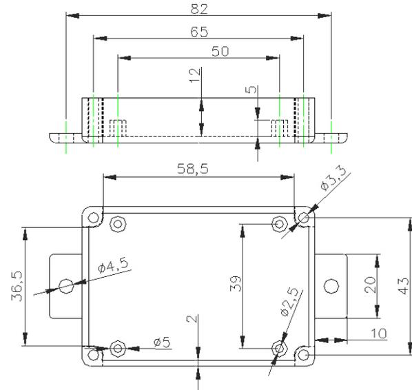
Gehäuseunterteil und Oberteil schwarz mit Befestigungslaschen und innenliegenden Befestigungsmöglichkeiten für Platinen.
