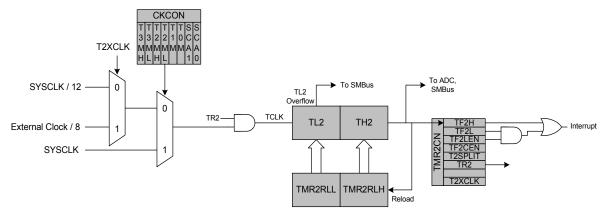
Figure 18.11. Timer 2 16-Bit Mode Block Diagram
