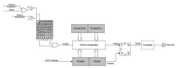
Figure 19.9. PCA 16-Bit PWM Mode
