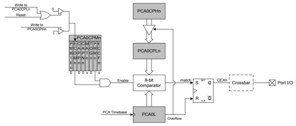
Figure 19.8. PCA 8-Bit PWM Mode Diagram
