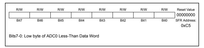
Figure 5.14. ADC0LTL: ADC0 Less-Than Data Low Byte Register
