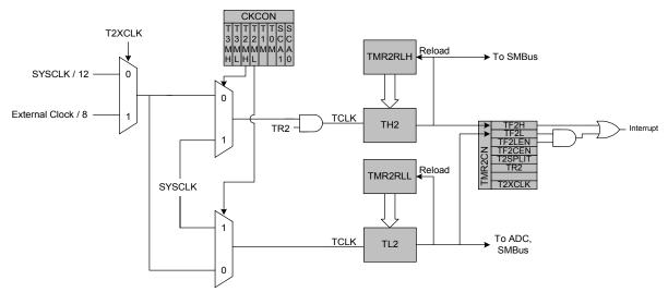
Figure 18.12. Timer 2 8-Bit Mode Block Diagram
