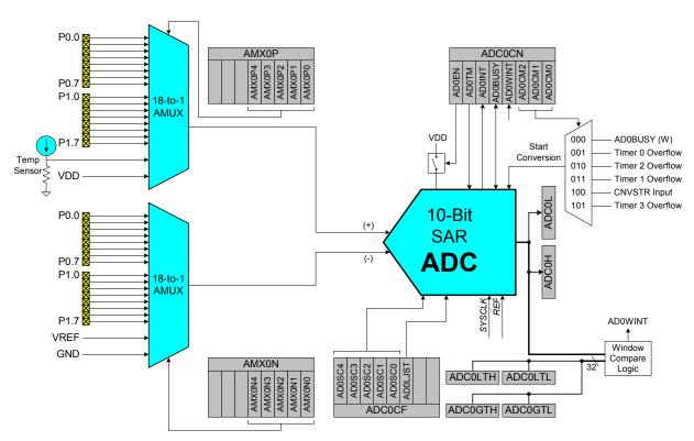
Figure 1.10. 10-Bit ADC Block Diagram
