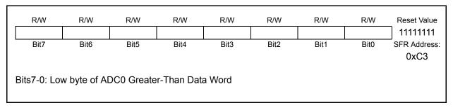
Figure 5.12. ADC0GTL: ADC0 Greater-Than Data Low Byte Register
