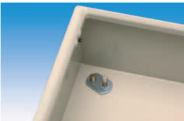
Установка настенного крепежа у шкафов ENSTO CUBO E очень проста: контргайка монтажная для настенного крепежа (EFLM4) надевается на винт монтажной панели. Таким образом настенный крепеж может легко монтироваться на шкаф с наружной стороны корпуса.
