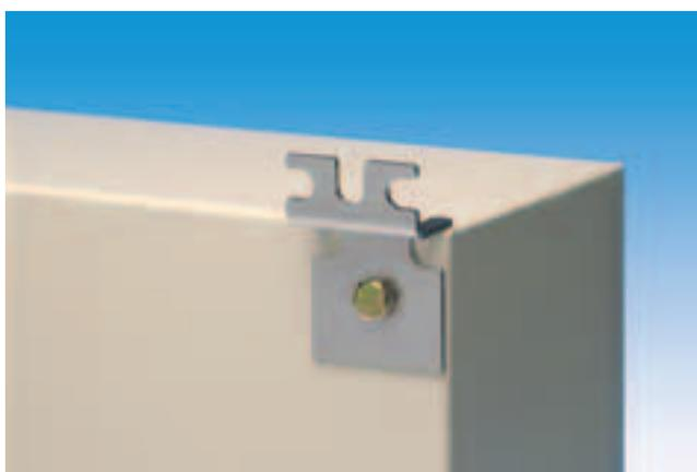
Настенный крепёж поставляется в двух вариантах исполнения: высота 20 мм (артикул EFFL2.20) и высота 50 мм (артикул EFFL2.50). Материал - нержавеющая сталь. Монтируется вертикально либо горизонтально.
