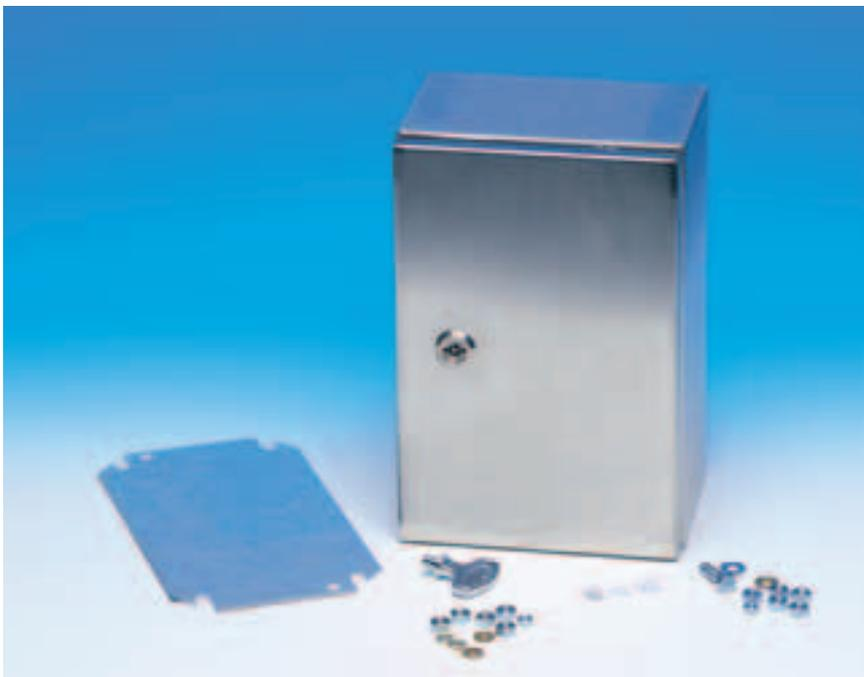
Комплект поставки корпуса CUBO E из нержавеющей стали включает монтажную панель с 8 винтами, ключ DIN-3, маркировку заземления, клемму заземления в виде гайки M6. Для заземления монтажной панели имеется винт M8 с соответствующими шайбами.
