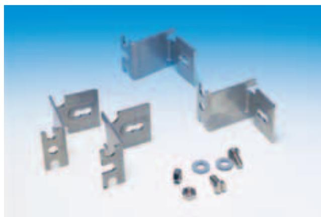
Настенный крепёж поставляется в виде комплекта из 4 шт. Высота 20 либо 50 мм. Кронштейны настенного крепежа могут крепиться снаружи корпуса в самый последний момент перед установкой готового шкафа. Данный способ позволяет избежать проблем при транспортировке.
