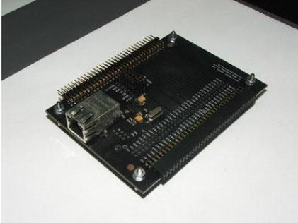
**EA-EDU-002** – плата расширения серии Education Board для микроконтроллеров LPC2148 с интерфейсом Ethernet 10M. Плата предназначена для ознакомления, разработки и быстрого запуска устройств на базе ARM7TDMI-микроконтроллеров производства PHILIPS. На плате реализовано множество уникальных возможностей, доступных через специальный интерфейс расширения, которые существенно облегчают процесс разработки.
