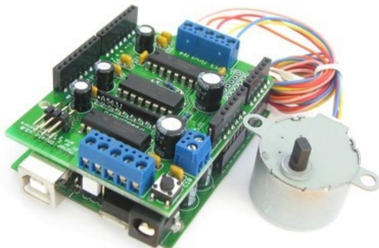
У шагового двигателя ST28 32 шага на оборот, а также встроенный редуктор с передаточным числом 64, что дает  $32 \cdot 64 = 2048$  шагов двигателя на один оборот выходного вала. В приведенном примере осуществляется поворот на один оборот в прямом направлении в режиме SINGLE, на один оборот в обратном в режиме DOUBLE, на пол-оборота в прямом направлении в режиме INTERLEAVE, и на пол-оборота в обратном в режиме MICROSTEP.
