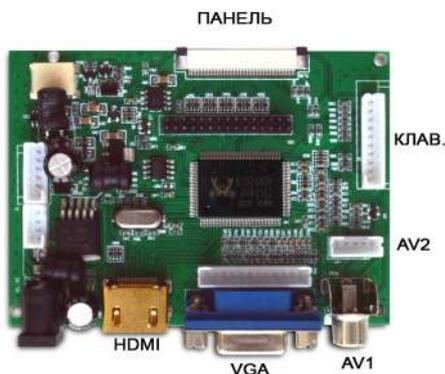
Рис.1. Видеоплата и назначение разъемов
