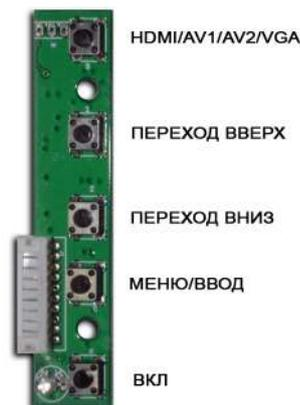
Рис.2. Назначение кнопок
