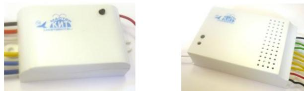
Одноканальное и двухканальное радиоуправляемые реле МР3328, МР3330, МР3331.
