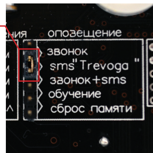
Рис. 4 Переключатель для настройки режима оповещения
