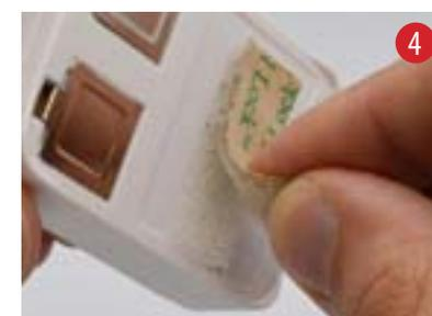
Снимите защитную плёнку с другой стороны и прикрепите датчик к выбранному месту установки.
