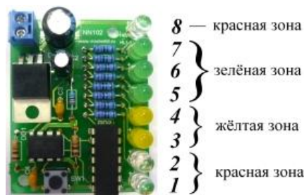
Цветовые зоны светодиодной шкалы устройства. Рис. 5
