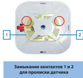
В случае удачной прописки радиодатчика в память радиобазы, на радиобазе прозвучит звуковой сигнал «ПИ-ПИ-ПИПИПИ».
