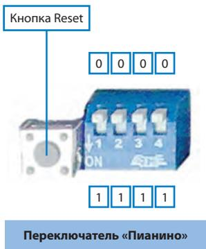
ществляется путем переключения рычажков на микропереключателе «пианино». Всего доступно 16 радиоканалов. По умолчанию система работает на нулевом канале (0000 на переключателе).
