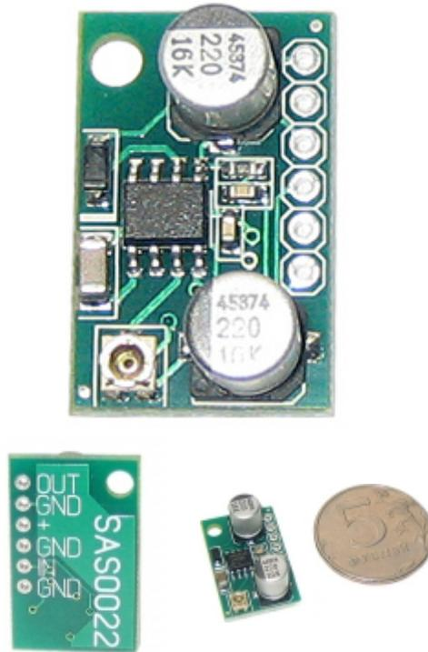
Миниатюрные размеры модуля позволяют встраивать его в различные электронные приборы, игрушки, активные колонки и т.п., где не требуется высокая выходная мощность. Подстроечным резистором на плате модуля регулируется уровень входного сигнала. При включении модуль начинает работать сразу и не нуждается в какой либо настройке.
