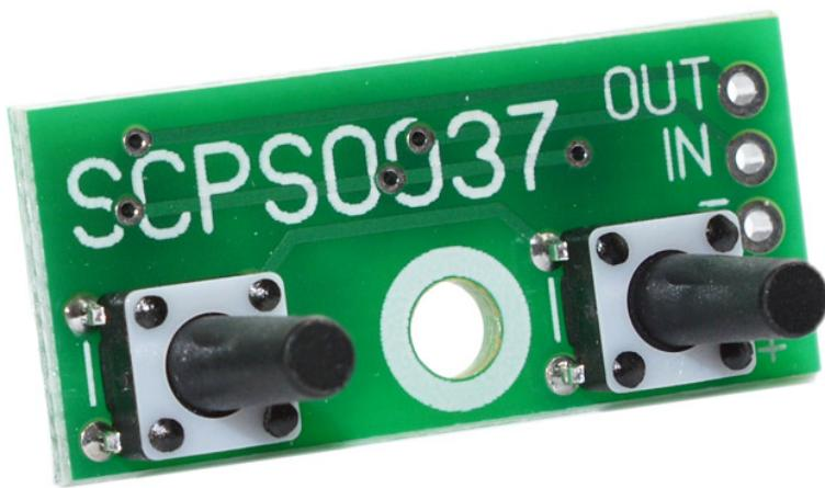
Контроллер импульсного стабилизатора предназначен для кнопочной регулировки выходного напряжения в импульсных стабилизаторах напряжения, таких как **SCV0023**, **SCV0026**, **SCV0033** и аналогичных. Модуль позволяет регулировать выходное напряжение стабилизатора в указанном диапазоне с шагом регулирования при помощи кнопок.
