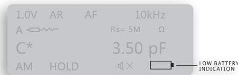
Значок пустой батареи на дисплее сообщает о том, что напряжение батареи снижается и она должна быть заряжена. Предупреждение появляется, когда напряжение батареи опускается ниже 3,55 В, т. е. батарея разряжена примерно на 90%. Устройство еще может работать некоторое время, но батарея должна быть заряжена как можно скорее.
