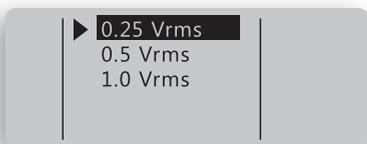
Используйте это меню для того, чтобы установить желаемый уровень испытательного сигнала.
