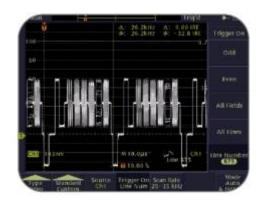
Все осциллографы TDS3000В имеют стандартную возможность синхронизации по сигналам NTSC, PAL и SECAM (все кадры или строки). Дополнительный модуль TDS3VID расширяет эту базовую видеосинхронизацию следующими особенностями: **Быстрое видеоменю** позволяет отобразить нижнюю и боковую панель, содержащую видеофункции для отображения и измерения стандартных телевещательных сигналов.
