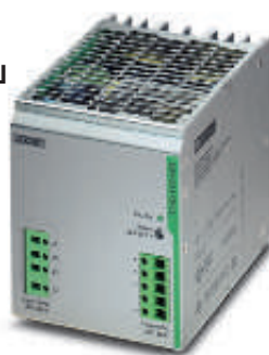
Источник питания, трехфазный, 24 В пост. тока, 20 А
