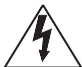
Знак молнии в равностороннем треугольнике проставляется для того, чтобы предупредить пользователя о наличии внутри корпуса изделия неизолированных элементов, находящихся под “опасным напряжением”, величина которого достаточна для того, чтобы представлять опасность поражения человека электрическим током.
