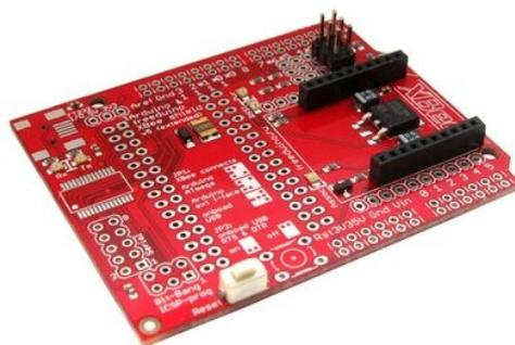
В комплект поставки входит XBee Shield, разъемы Arduino Nano и разъемы «классической» Arduino. При использовании плат в формате Arduino Nano внимательно следите за ориентацией платы и устанавливайте ее согласно иллюстраций, а также ориентируясь по первому выводу, имеющему квадратную площадку под пайку.
