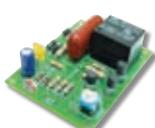
С помощью этого устройства можно автоматизировать включение-выключение ночного освещения в прихожей многокомнатной
