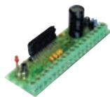
Основное назначение автомобильного усилителя НЧ – установка в вашей автомагнитоле, вместо старого усилителя НЧ, для повышения ее
