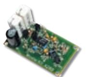
Преобразователь предназначен для питания от автомобильного аккумулятора напряжением 12 В бытовых приборов, теле- и радиоаппаратуры,
