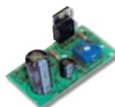
Регулируемый стабилизатор напряжения можно использовать для питания бытовых устройств, в радиолюбительской лаборатории и т.д.
