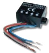
Данный модуль универсального предварительного усилителя можно использовать для предварительного усиления сигнала, например, от микрофона, электромагнитной
