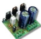
Устройство обладает малыми габаритами, широким диапазоном питающих напряжений и сопротивлений нагрузки. УНЧ можно
