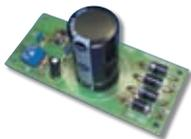
Выходное напряжение стабилизатора регулируется в пределах 1,2...20 В с максимально допустимым током 1 А.
