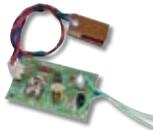
Этот набор предназначен для контроля уровня воды в баке, ванне и других емкостях. По сигналу датчика происходит
