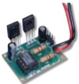
Это простое устройство позволит радиолюбителю использовать стандартный однополярный источник постоянного напряжения для питания
