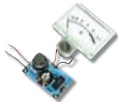
Предлагаемый набор позволит радиолюбителю собрать устройство, сигнализирующее об утечке газа. Детектор газа имеет
