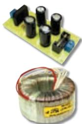
Данные двуполярные нестабилизированные сетевые источники питания состоят из силового тороидального трансформатора (входит в комплект набора), двух блоков выпрямителей с диодным мостом и фильтрующими емкостями.
