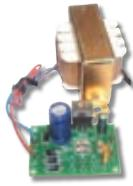
Предлагаемый к сборке набор позволяет собрать радиолюбителю стабилизированный источник питания с возможностью фиксированного выбора выходного напряжения: 6, 9 или 12 В.
