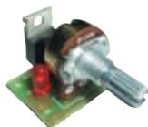
Предлагаемый набор позволит радиолюбителю собрать регулятор мощности, предназначенный для регулировки мощности нагрузки до 500 Вт
