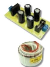
Данные однополярные нестабилизированные сетевые источники питания состоят из силового тороидального трансформатора, блока выпрямителя с диодным мостом и фильтрующими емкостями.
