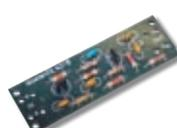
Антенный усилитель предназначен для улучшения качества радиоприема автомобильных магнитол и радиоприемников.
