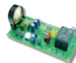
С помощью этого устройства можно автоматизировать включение-выключение освещения или других бытовых
