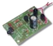
Миниатюрный таймер предназначен для формирования сигналов задержки включения/выключения исполнительного устройства.
