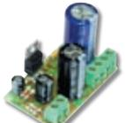
Устройство обладает малыми габаритами, широким диапазоном питающих напряжений и сопротивлений нагрузки. УНЧ можно использовать как
