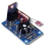
Из шести радиоэлементов можно собрать миниатюрный автоматический выключатель освещения. Чувствительность устройства регулируется
