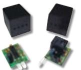
Данный набор предназначен для использования в качестве датчика охранной системы. Инфракрасный барьер может найти применение на стадионах
