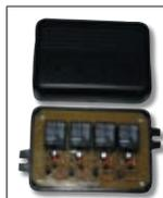
Предлагаемый набор позволит собрать 4-х канальное исполнительное устройство, рассчитанное на работу с 4-мя независимыми нагрузками с максимальными параметрами 6 А/277 В.
