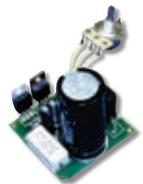
Мощный лабораторный блок питания имеет выпрямитель переменного напряжения и фильтр, снижающий уровень пульсаций напряжения на входе стабилизатора.
