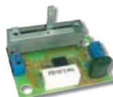
Устройство предназначено для регулирования мощности электронагревательных, осветительных приборов, мощности
