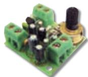
Высококачественный усилитель предназначен для работы с любым микрофоном с сопротивлением 4...100 кОм. Наличие независимой
