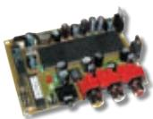
Декодер стереозвукового сопровождения формата NICAM предназначен для установки в любые телевизоры
