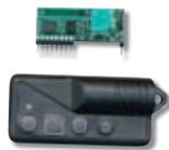
Устройство дистанционного управления представляет собой комплект из четырехкнопочного передатчика, сделанного в виде брелока, и приемника,
