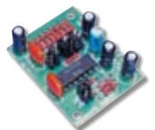
строительство используется в качестве микрофонного предусилителя в стереофонической аппаратуре У при записи и воспроизведении звука.
