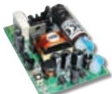
Предлагаемый блок в собранном виде позволяет реализовать принцип: купил – подключил. Надежный импульсный источник питания, обладающий
