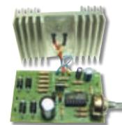
Предлагаемый набор позволит радиолюбителю собрать регулятор напряжения 0–30 В. Устройство можно использовать в качестве лабораторного источника питания.
