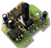
Устройство предназначено для регулирования яркости ламп накаливания мощностью до 600 Вт (50 А).
