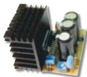
Простой и надежный мощный малогабаритный усилитель НЧ, работающий в классе Н (с вольтдобавкой), обеспечивает выходную
