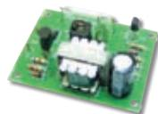
Стробоскоп выполнен на импульсной ксеноновой лампе и прост в изготовлении.
