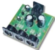
Разветвитель видеосигналов - это специальный усилитель, который позволяет подключить к одному источнику аудио-видеосигналов
