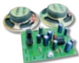
Предлагаемый к сборке набор «проводное переговорное устройство» позволит организовать проводную телефонную
