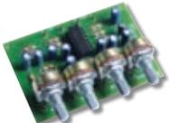
Предлагаемый набор позволит радиолюбителю собрать простой и надежный трехканальный предварительный микрофонный усилитель.
