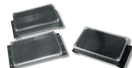
Стандартные корпуса с прозрачной крышкой, разной высоты с основанием 120x70 мм. Корпуса состоят из четырех частей: нижняя часть, в которой предусмотрена возможность крепления платы внутри корпуса посредством шурупов, изготовлена из черного пластика; верхняя часть выполнена из прозрачного пластика. У каждого корпуса имеются две прикручивающиеся наклейки для крепления к стене.
