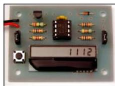
**Малогабаритный частотомер «ASSISTANT F-50».** Прибор позволяет измерять частоту: 1 Гц...50 МГц. Семиразрядный индикатор, высота символа 12 мм. Размер: 115x70x25 мм.
