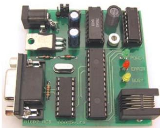
**Внутрисхемный отладчик** в виде набора деталей для самостоятельной сборки
