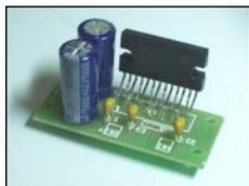
**EK-1557 - двухканальный усилитель с выходной мощностью 22Вт на каждый канал**
